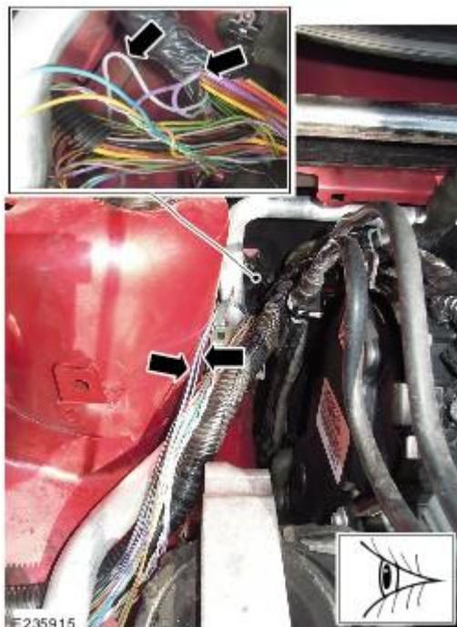
15. Отрежьте одиночный провод **фиолетово-зеленого** или **серого** цвета в подходящем месте. Чтобы вытянуть провода из моторного отсека, закрепите новые провода (см. «Общее оборудование»).
